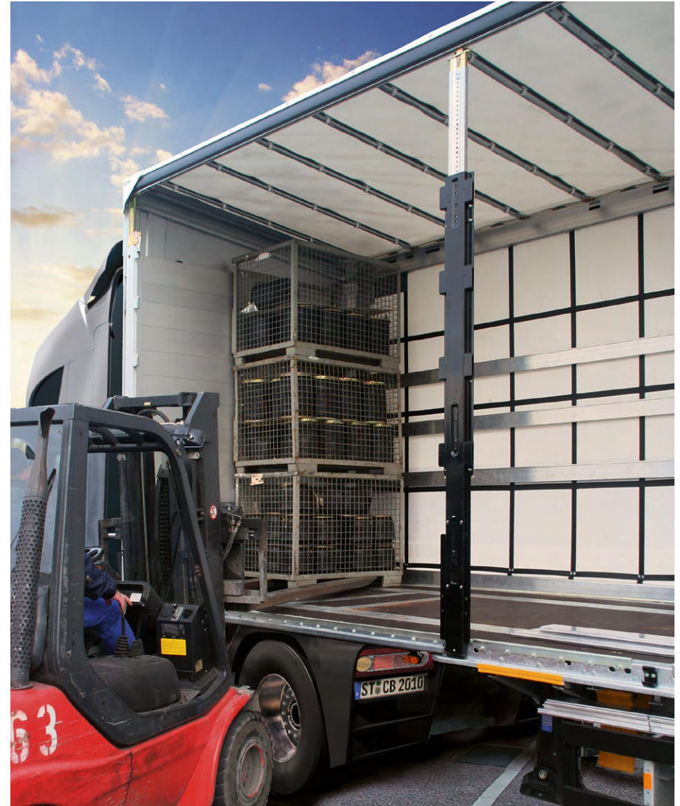
Kai pakraunamas krovinytis ir pakeltas stogas vėl nuleidžiamas, konteinerio tipo dėžės įsiremia į tentą ir visą kėbulo konstrukciją.
