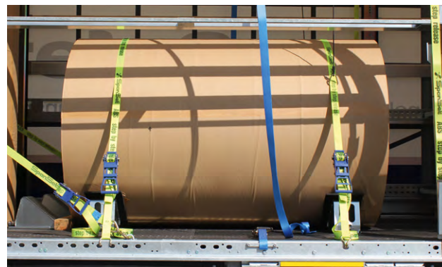
Popieriaus ritinys, paguldytas transporto priemonės judėjimo kryptimi. Prie grindų pritvirtintas dviem diržais, iš priekio ritinį saugo atraminiai fiksavimo pleištai.
