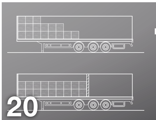
20 Įtvirtinimas atotampomis. Prispaudimo slėgio didinimas.
