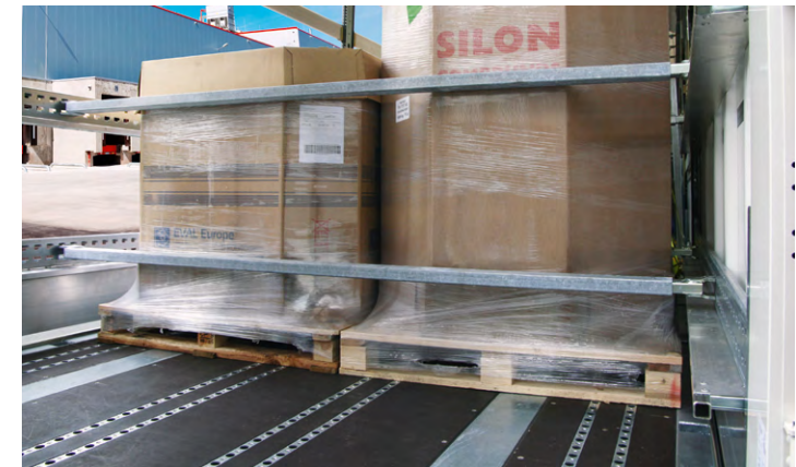
Horizontaliai įstatytos atraminės sijos užtikrina ant padėklų sukrautų „Octabin“ tipo krovinių dėžių tvirtinimą. Atraminės sijos fiksuoja krovinį išilgine kryptimi.
