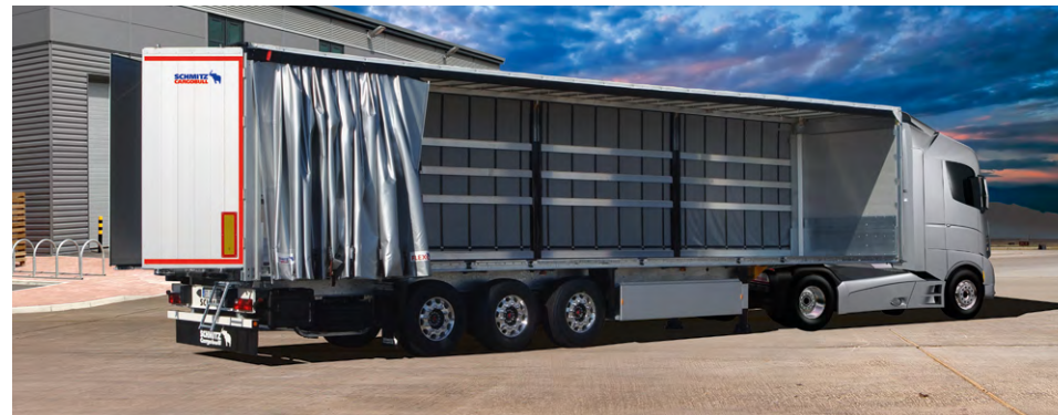
Krovinių tvirtinimo glaudžiu išdėstymu sąlyga – stabilus kėbulas.
