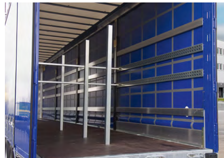
Gabenant profilius ir strypus būtini papildomi ranga grindyse ir plieninės perforuotos juostos su horizontaliais tvirtinimo skersiniais.
