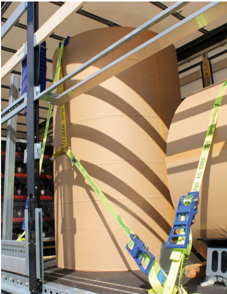
Vertikaliai pastatytas popieriaus ritinys, įtvirtintas diržais tiesiogiai ir prie grindų
