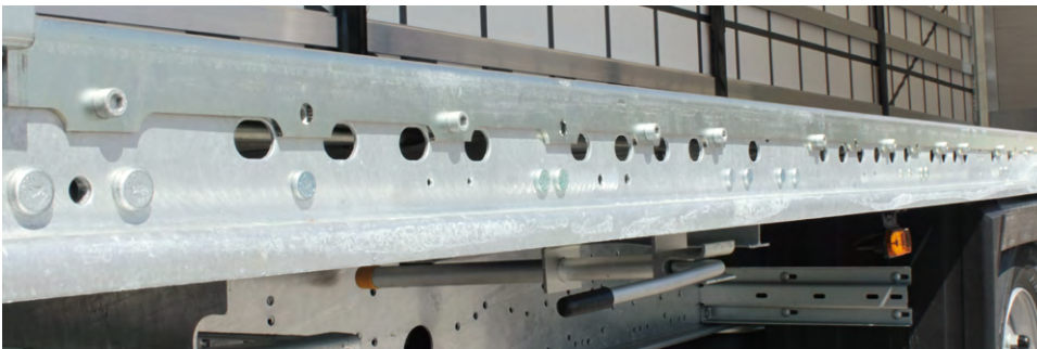
Perforuotas šoninis rėmas ir prie jo prisukti borteliai nuo padėklų nuslydimo leidžia beveik kiekviename taške paprasčiau pritvirtinti krovinį diržais prie grindų taip, kad jis neslankiotų į šonus.
