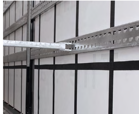
Puspriekabė su 1 skersine sija ir 2 plieninėmis lentomis esant daliniam pakrovimui.
