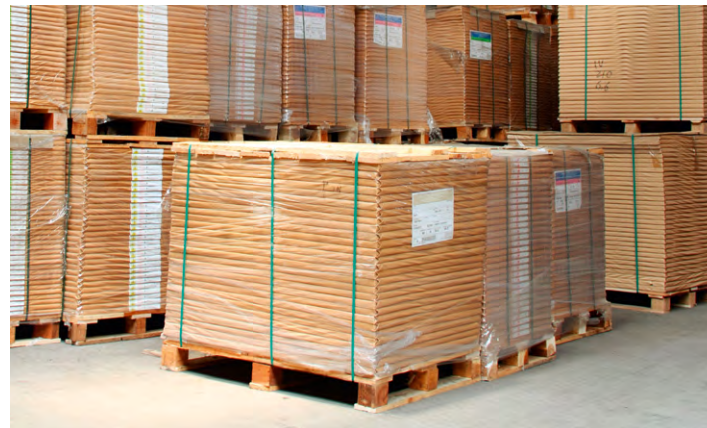
Čia pateikiamas pavyzdys, kaip galima lengvai suformuoti įtvirtintą krovinio vienetą.
