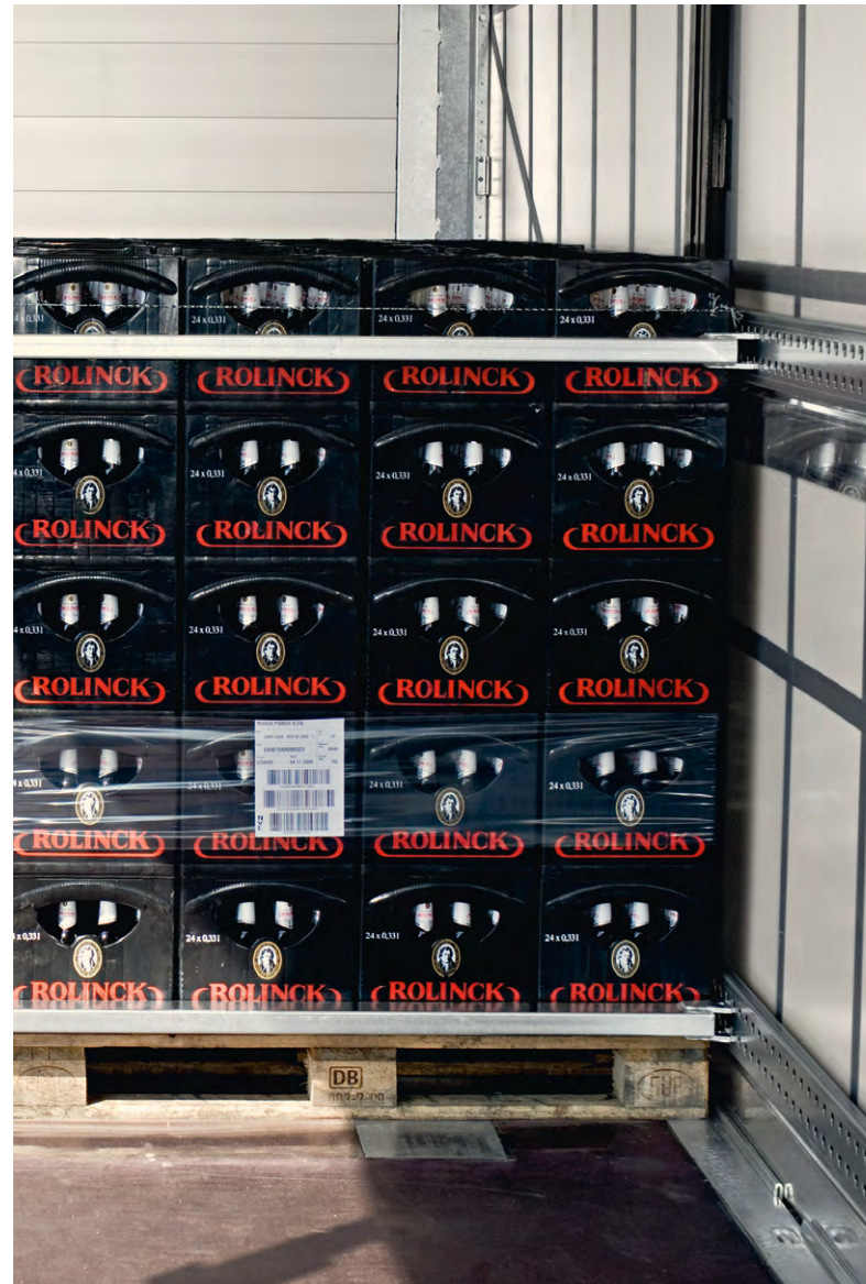
Skersinės sijos prieš krovinį ir už jo apsaugo dalinius krovinius nuo išilginio slydimo.
