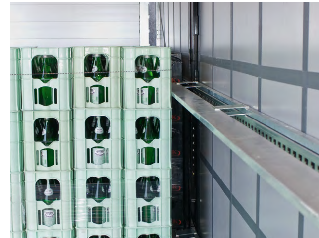
Distancinės pasukamos juostos atlenkiamos taip, kad gabenamų gėrimų dėžių ant padėklų šonuose neliktų tarpų.
