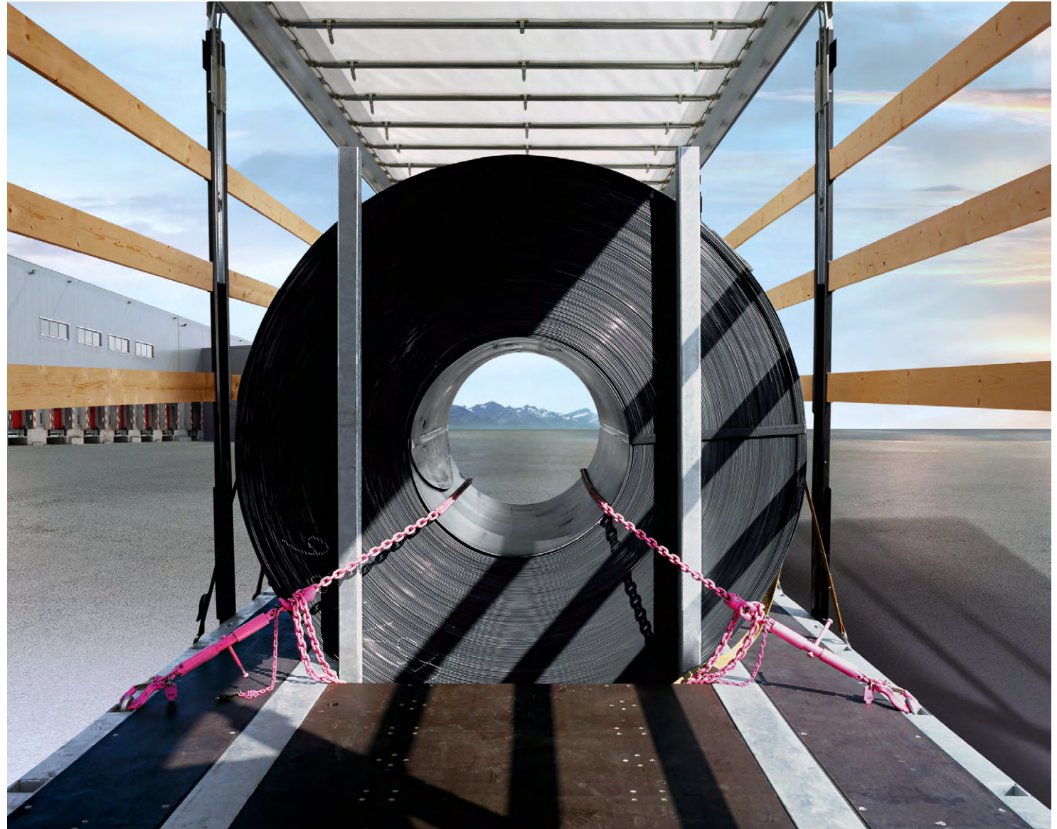
Plieno ritė glaudžiai įtvirtinta naudojant specialų lovį, įstatomus statramsčius ir grandines, įkabintas į didelei apkrovai pritaikytas kilpas.
