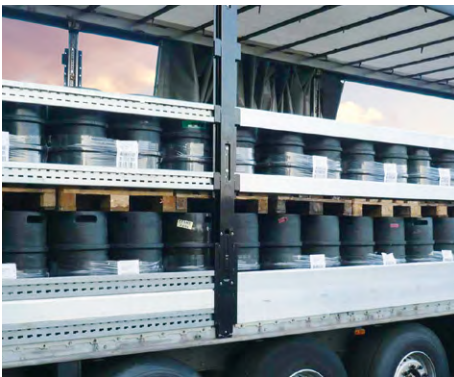
Tinkamai pritvirtintos statinės transportavimui.
