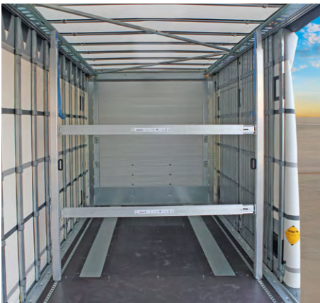
Lanksčiai išdėstomų atramų ir atraminių sijų sistema.
