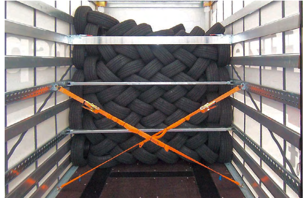
Palaidos, „pynute“ sukrautos padangos gabenimo metu linkusios susmukti ir daryti didelį spaudimą į šonus. Todėl būtina užtikrinti kėbulo stabilumą šonus įtvirtinant.
