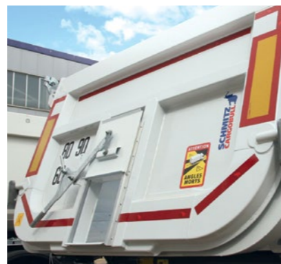
Porte hydraulique : Totalement pilotable elle peut être utilisée en version oscillante simple ou hydraulique. Options parfaites pour travailler au finisseur.
