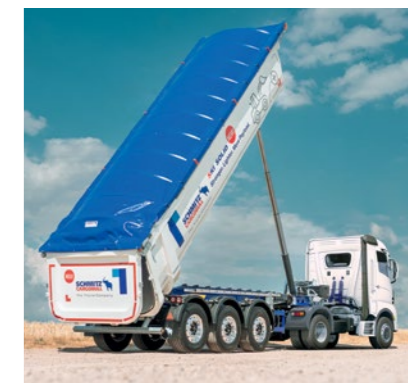
Bachage longitudinal: Manuel ou électrique, il est à associer à la télécommande pour un usage au finisseur ergonomique et sécurisant.
