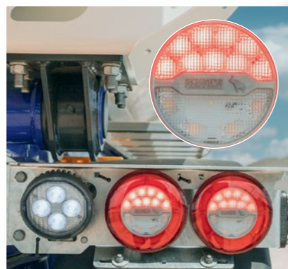
Feux arrière LED à trois compartiments avec design Schmitz Cargobull et clignotants dynamiques. Feux arrière en position haute de série. Feux de travail à LED** pour l'éclairage de la zone de déversement.
