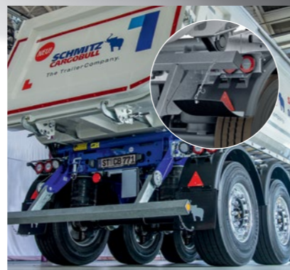
Barre anti encastrement arrière compatible finisseur. Au choix.; Relevage manuel, relevage manuel assisté par un mécanisme à ressort ou, pour une meilleure maniabilité, en version pneumatique.
