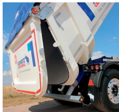
Porte arrière oscillante. Adaptée au déchargement partiel, elle peut être équipée d'un portillon.
