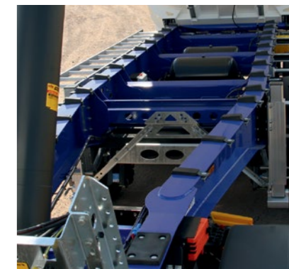
Châssis en acier résistant à la torsion et doté d'une protection anticorrosion améliorée, en finition peinte ou galvanisée, pour une plus grande longévité et une meilleure valorisation à la revente.
