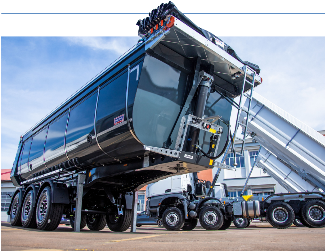
Klassischer Sattelkipper für den Asphalttransport mit elektrischem Schieberverdeck.
