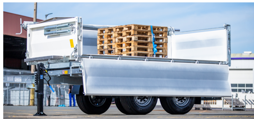
Dank Zurrpunkten im Muldenboden ist der Z.KI auch für den Transport von Palettenware geeignet.
