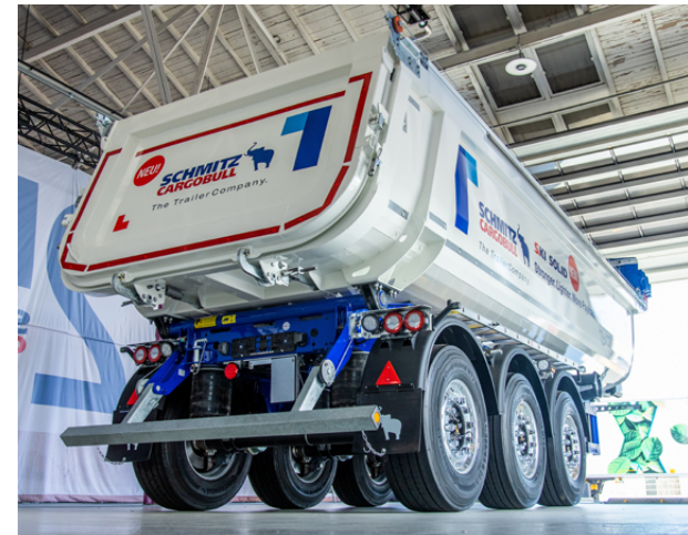
Die neuen Mulden und Rahmen für S.KI und M.KI gehen im ersten Quartal 2023 in Produktion und bieten bis zu 280 Kilogramm mehr Nutzlast.
