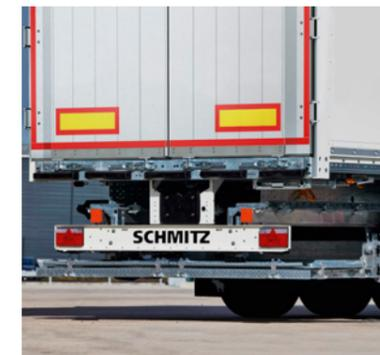
**Unterfahrbare Ladebordwand\*** für Verteilerverkehr, das Be- und Entladen ohne Rampe.
