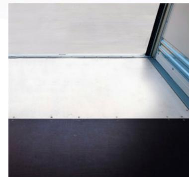
**Langlebiger und robuster Siebdruckboden** bis 8.000 kg\* Staplerachslast nach DIN 283. Durch versiegelte Bodenplatten gelangt von unten keine Feuchtigkeit an die Fracht. Verschleißblech\* schützt den Boden am Heck.
