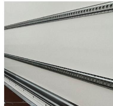
**Aufgesetzte Ladungssicherungsschienen\* für waagerechte Balken, Spann Gurte und Sicherungspläne.**
