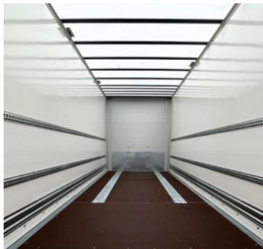
**Aluminium-Stirnwand mit Sockelscheurleiste aus verzinktem Stahl:** Schutz für Fracht und Trailer.
