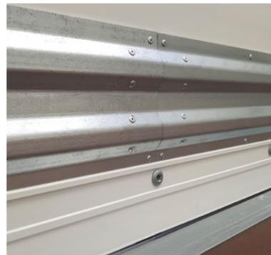
**Robuste Heavy-Duty Sockelscheurleiste,** damit die Seitenwand geschützt wird und die Ladungsprozesse schneller werden.
