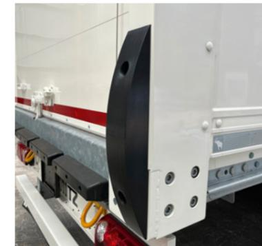
**Heavy Duty Eckenschutz\*** in Verbindung mit Rolltor\* für schnellen Zugang an der Rampe und im Verteilerverkehr
