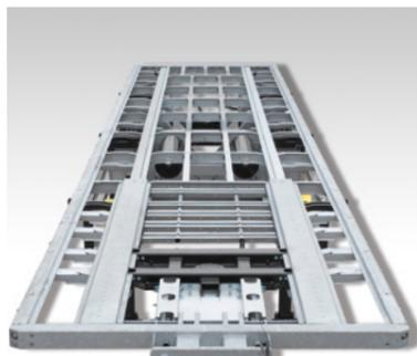
**Rolliertes MODULOS-Chassis:** Korrosionsbeständig und reparaturfreundlich dank der gebolzten und feuerverzinkten Technologie.
