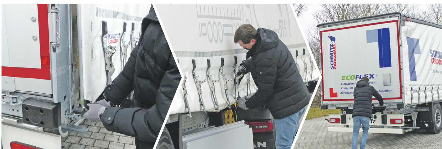
Routine: Das Festratschen der Spannstange strafft die Plane horizontal. Die Spanner sind schon hoch gehängt in Stellung „kurz“.
