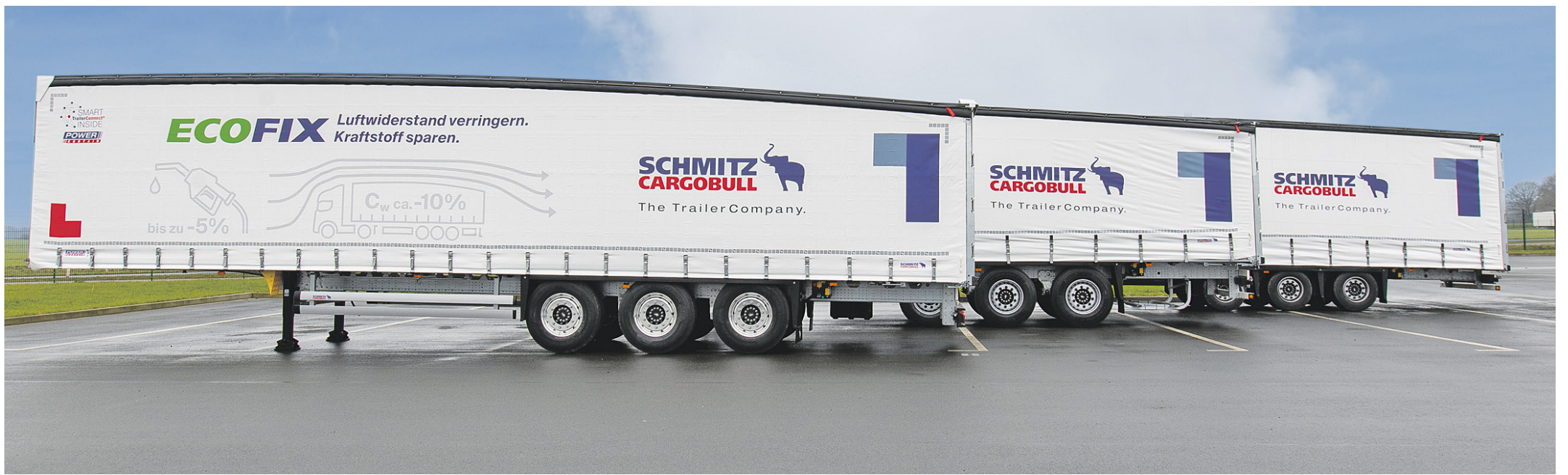
Heckformen im Vergleich: Beim EcoFix mit fester Aero-Geometrie liegt die Plane superglatt an. Beim EcoFlex (Mitte) und dem Volumenmodell EcoVarios ist die Plane im oberen Eckbereich nicht hundertprozentig glatt.
