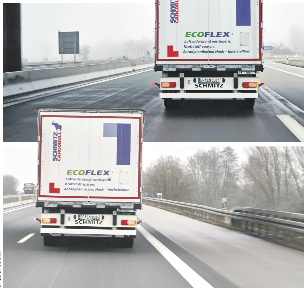
Bei abgesenktem Heck verringert sich die Durchladehöhe am Heckportal um einen halben Meter (2.550 mm zu 2.050 mm).
