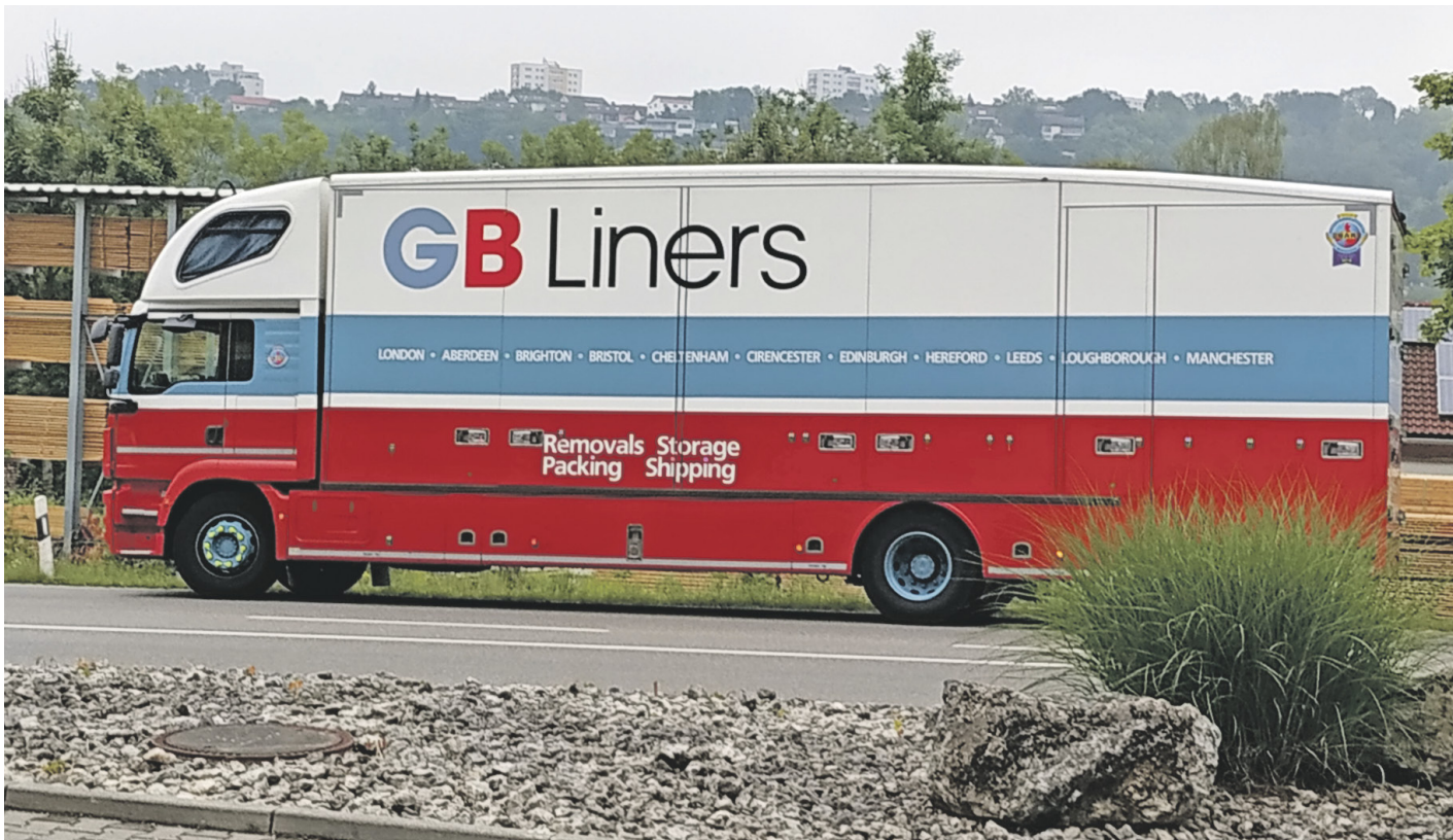
Dieser britische Möbel-Truck definiert durch seine Form den Begriff „Teardrop“: Vorne steigt der Aufbau langsam an, bildet kurz hinter der Mitte einen Buckel und fällt hinten wieder ab.
