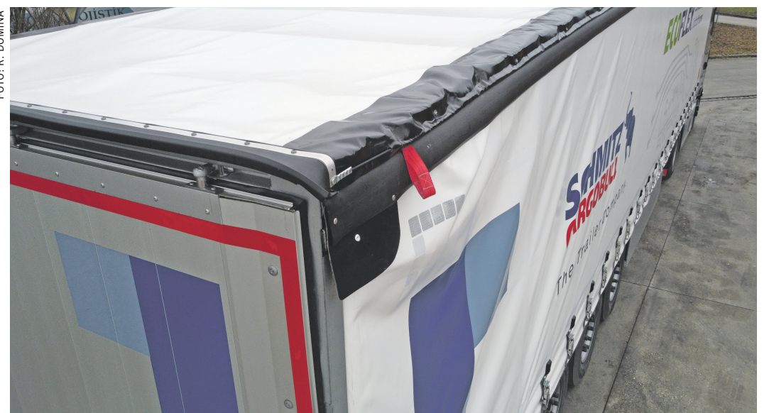
Durch die Wölbung der Seitenlinie verändert sich die Geometrie der Seitenplane. Weil die Spannstrange das überschüssige Tuch nicht aufnehmen kann, entstehen Falten. Die Entwickler arbeiten an einer Lösung.
