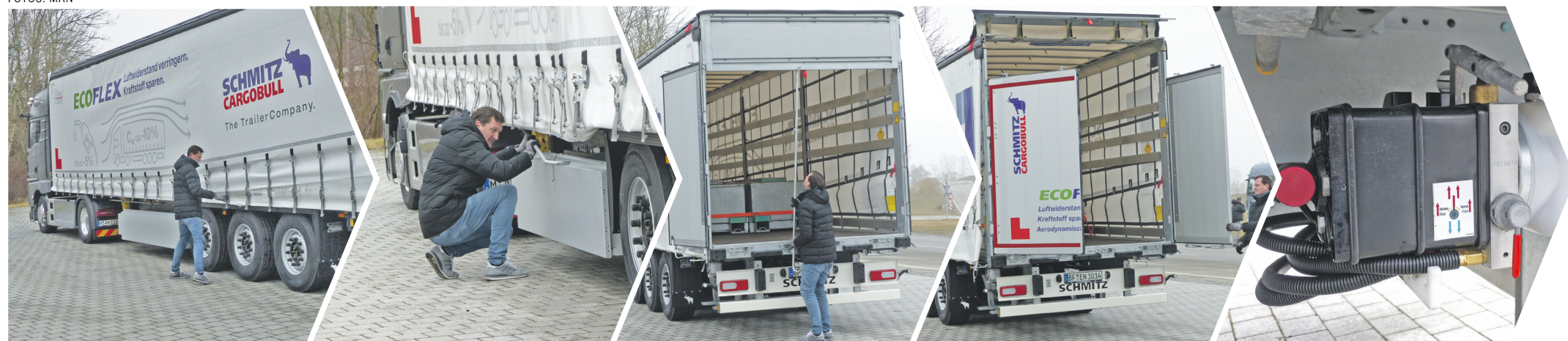
Bei abgesenktem Heck verringert sich die Durchladehöhe am Heckportal um einen halben Meter (2.550 mm zu 2.050 mm).
