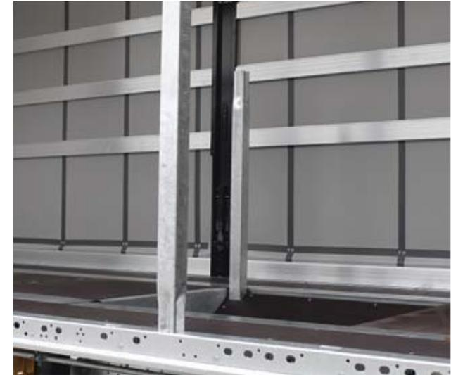
In den Boden einsteckbare Rungen (Bild oben) oder in den Aufsatzlatten verankerte Querbalken (Bild links) ermöglichen formschlüssiges Laden trotz Lücken in der Ladungsanordnung, z. B. bei Teilladung.
