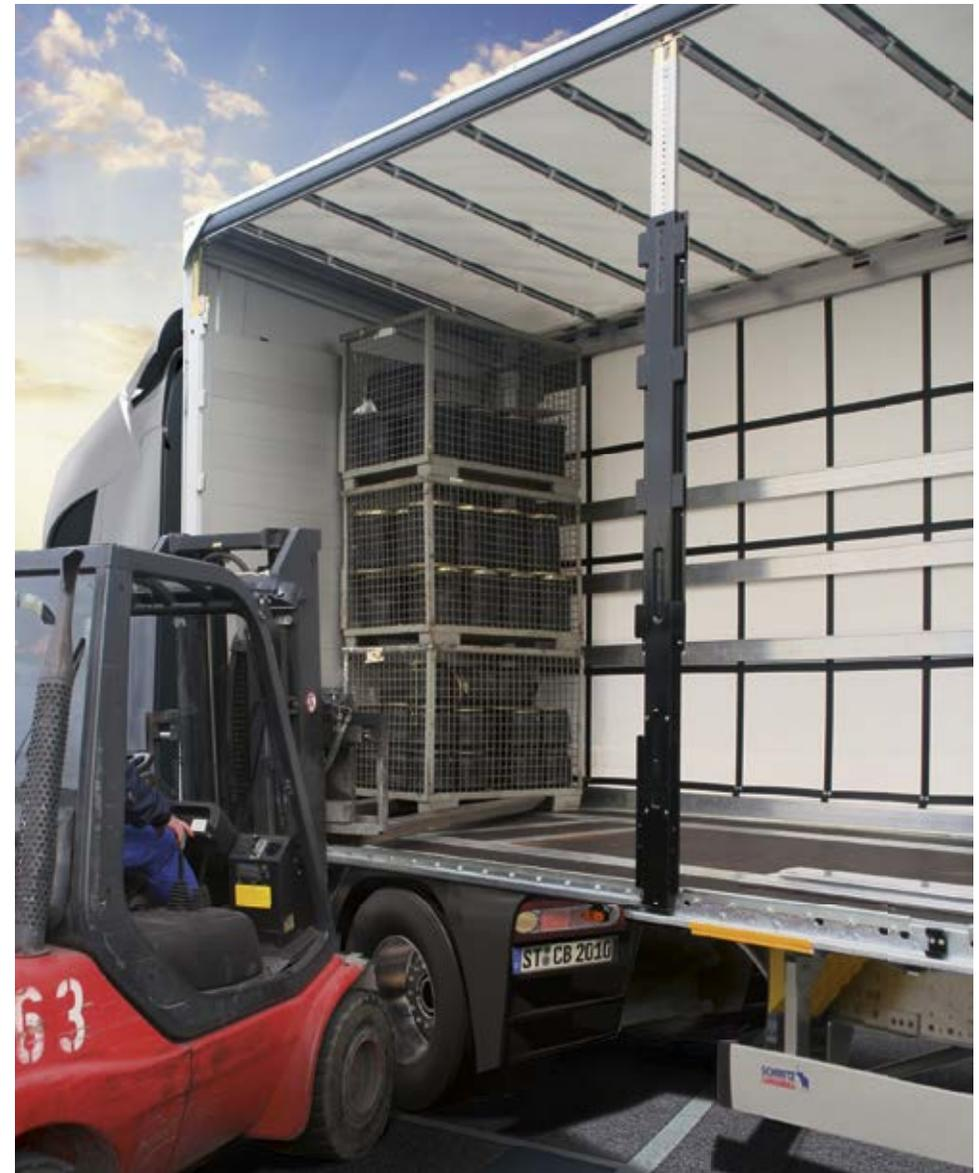
Wird das zur Beladung angehobene Hubdach wieder abgesenkt, sind die Gitterboxen vom Aufbau allseitig passgenau umschlossen.
