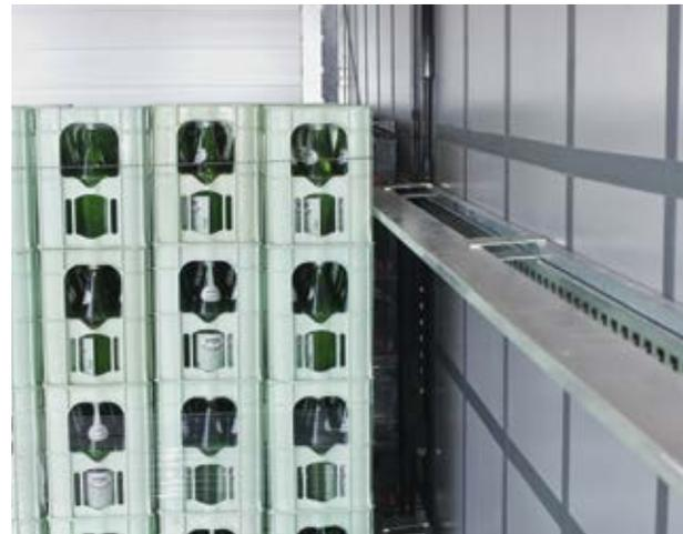
Distanz-Wende-Latten werden so abgeklappt, dass sie einen seitlichen Formschluss für den Transport von Brunnenpaletten bilden.
