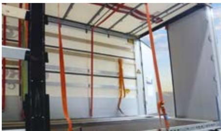
Das zwischen den Dachholmen angebrachte Sliding Lashing-System ermöglicht eine individuelle Ladungssicherung. Verschiebbare Retainer nehmen Ladungssicherungsgurte auf. So können diese auf jede beliebige Position im Laderaum verschoben werden.
