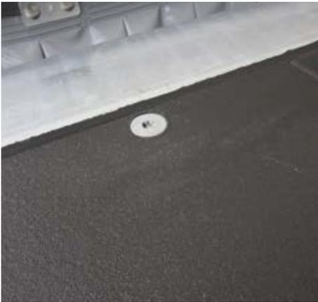
Der Antirutschboden erspart das Hantieren mit Antirutschmatten und ist die erste Wahl bei amorphen Ladungen wie Big Bags.
