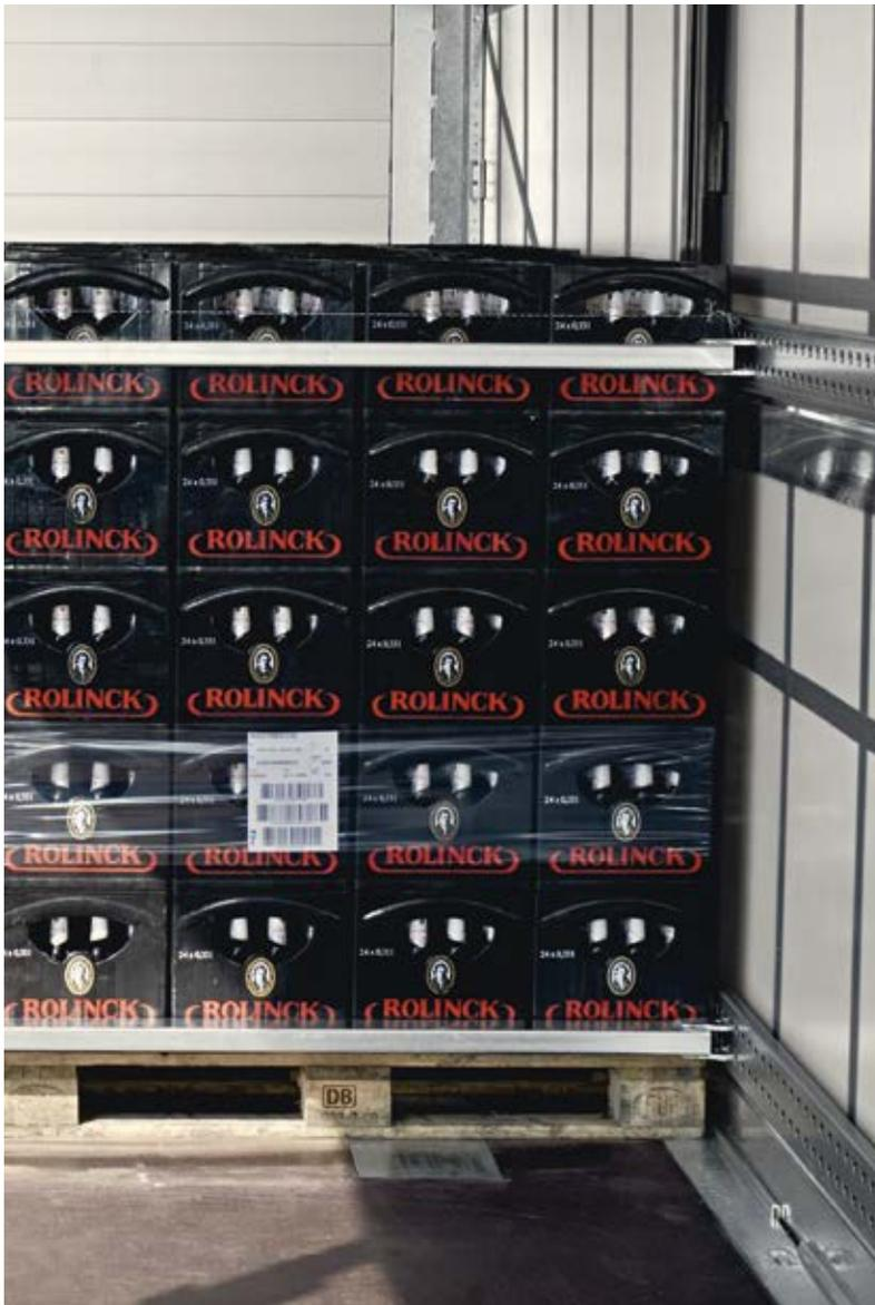
Querbalke vor und hinter der Fracht sichern Teilladungen gegen Verrutschen in Längsrichtung.
