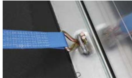
An den Gurten sind verschiedene Endbeschläge möglich. Hier ein Spitzhaken, der in eine versenkbare Zurröse am Außenrahmen greift.
