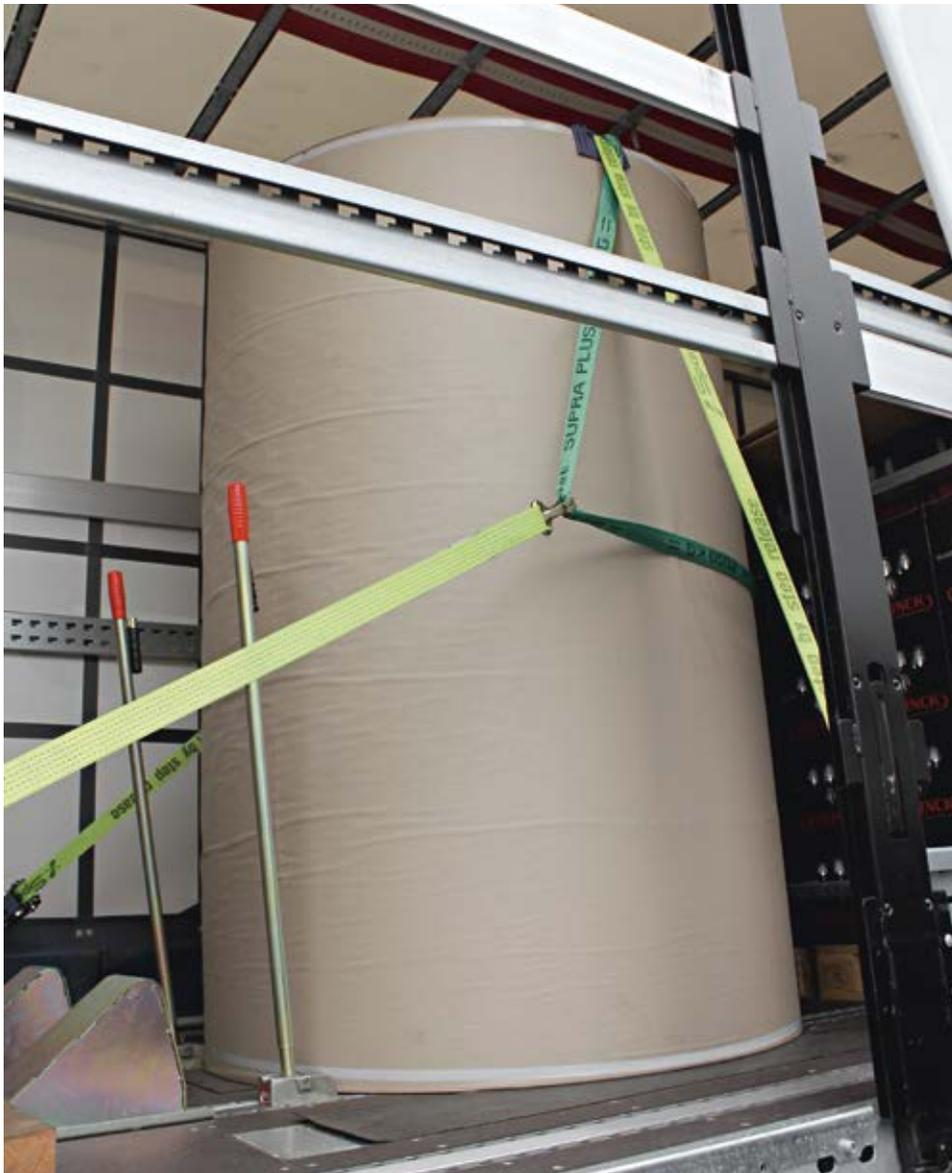
Papierrollen-Transport mit Sicherung durch Form- und Kraftschluss. Die Kopfflasche der stehenden Rolle sichert auch gegen Kippen.
