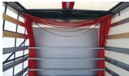
Bei Nichtgebrauch oder Beladung werden die Ladungssicherungsgurte einfach verschoben, bzw. durch die Retainer unter das Dach gezogen, so bleibt der Laderaum frei.
