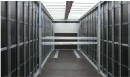
Senkrechte Stützen, die in Boden und Dach verankert sind, um die Gitterboxen im SPEED CURTAIN-Aufbau formschlüssig zu sichern.
