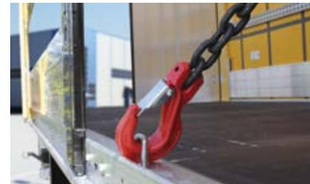
Zurrketten für große Lasten gehören an entsprechend ausgelegte Zurrösen, hier eine 5-t-Öse.
