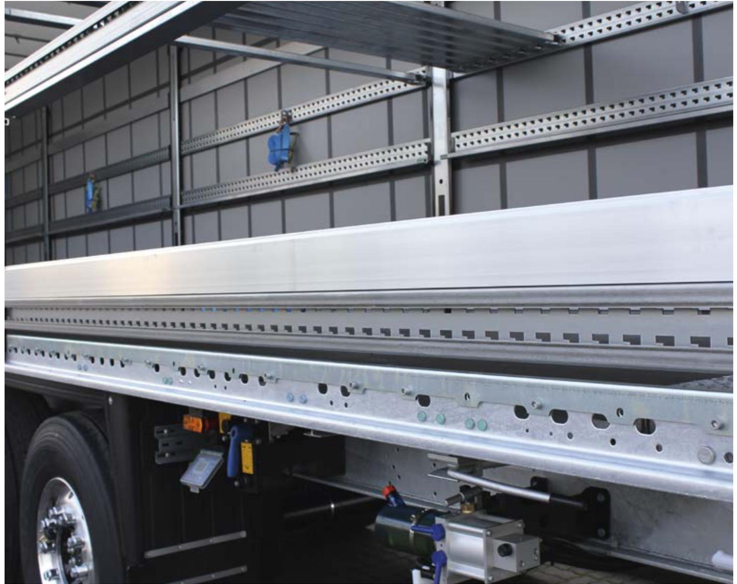
Stahl-Latten mit engmaschigem Raster zum Einhängen von Querbalken und Gurten lassen jede beliebige Teilung zu. Mit Aluminium-Latten kann eine stabile Bordwand zur Seite gebildet werden.
