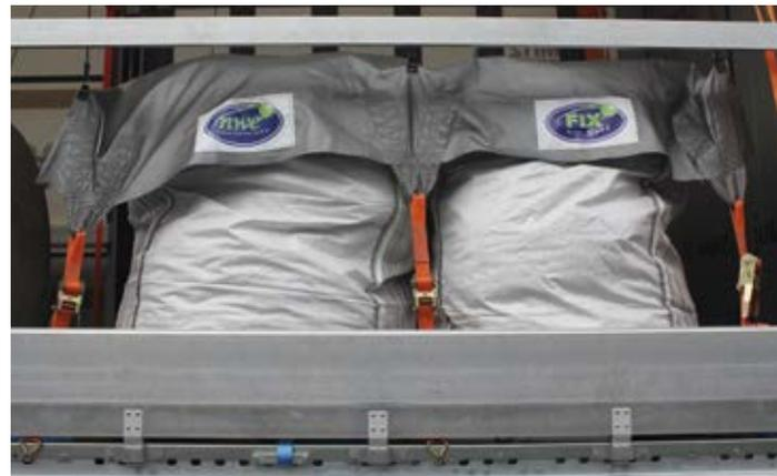
Formschlüssige Sicherung bei nachgiebigen Big Bags: Untere Seitenlatte durch Aluminium und Plane mit Zurrgurten.
