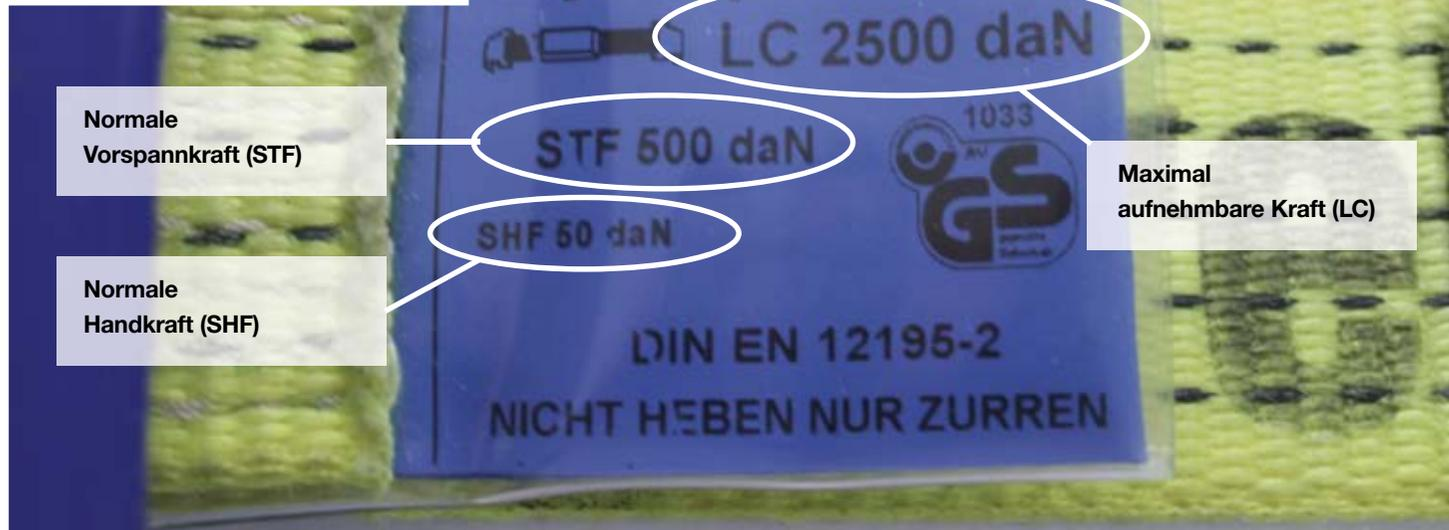
Maximal aufnehmbare Kraft (LC)
