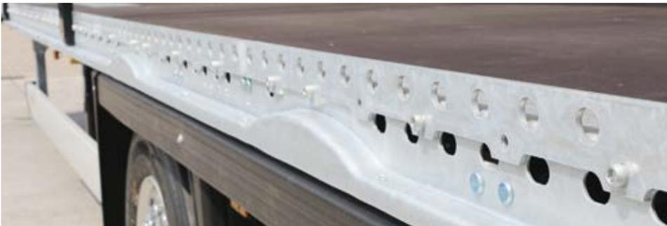
Eine durchgehende Zurrlochung im Außenrahmen und daran angeschraubte Palettenanschlagleisten ermöglichen vereinfachtes Niederzurren der Fracht an fast jedem Punkt und sichern die Ladung gegen seitliches Verschieben.
