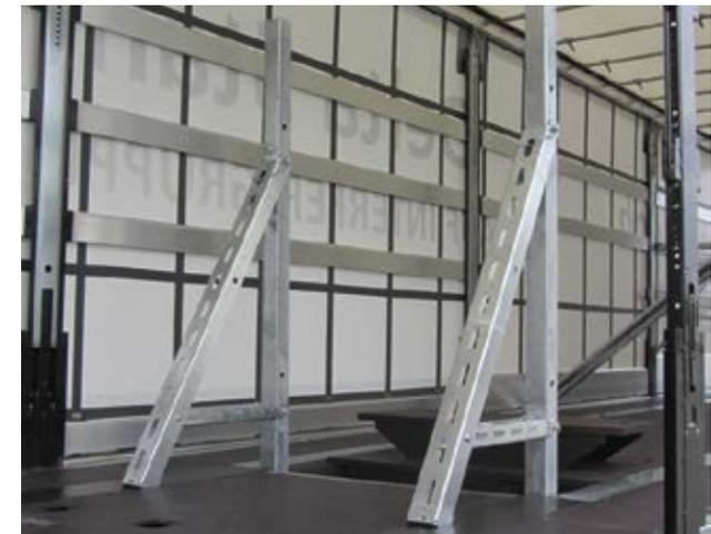
Bei besonders schweren Lasten wie Stahl-Coils können Steck-Rungen mit Streben eine formschlüssige Sicherung gewährleisten.
