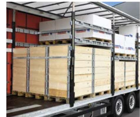
Querbalken können zum formschlüssigen Sichern von Teilladungen in die Rungen und seitlichen Doppelstock-Tragebalken eingehängt werden.
