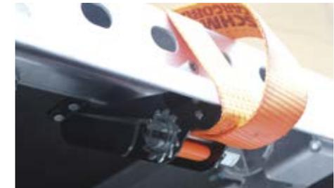
Fest installierte Winde mit Zurrgurt unterhalb des Außenrahmens.
