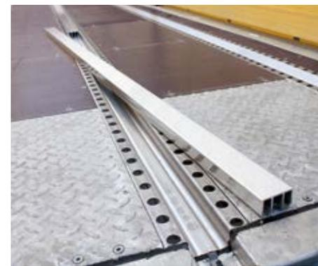
Die Joloda-Schienen mit Lochraster und stabilen Aluminium-Abdeckungen sind einfach zu reinigen und erleichtern das Handling und Sichern der Ladung.
