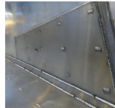
**Verschleißbleche** optimieren die Widerstandsfähigkeit der Mulde im Heckbereich.
