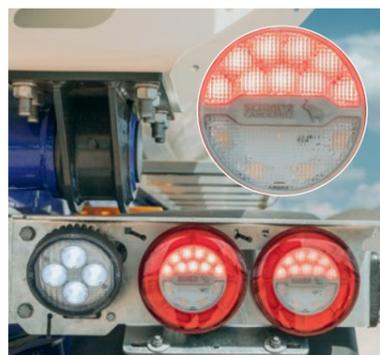
**LED-Dreikammerleuchten** im Schmitz Cargobull Design. Als Mehrkammerleuchten mit dynamischem Blinker. Alle Rückleuchten serienmäßig in hoher Lampenposition. LED-Arbeitscheinwerfer\*\* zur Ausleuchtung des Schüttbereichs.
