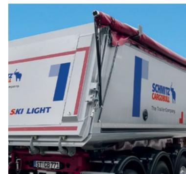
**Thermo-isolierte Ausführung\*** für den Asphalt-Transport. Messöffnungen für manuelle, direkte Temperaturmessung und Vorbereitung für den Einbau einer elektronischen Messtechnik.
