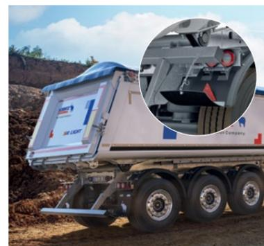
**Klappbarer Unterfahrschutz** mit hoher Bodenfreiheit für den Einsatz am Straßenfertiger. Wahlweise manuell bedienbar, mittels Federmechanik unterstützt oder für verbessertes Handling in pneumatischer Ausführung.
