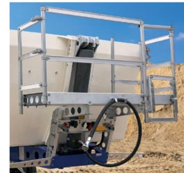
**Arbeitsbühne** mit rutschhemmendem Boden zur Bedienung der Rollplane. Inklusive Mulden-Einstiegshilfe und Parkposition für den Hydraulikschlauch.
