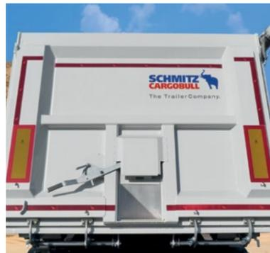
**Aufliegende Pendelklappe** – ist geeignet für Teilladungen. Optional mit Schieber.
