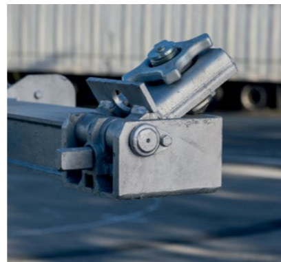
Klappverriegelung als PIN-Verriegelung für Tunnelcontainer am Frontbalken.
