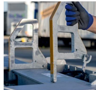
Leicht auswechselbare Containerführungen für Container am Frontbalken.
