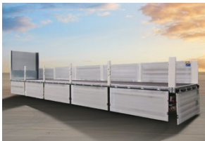
Abnehmbare Bordwände und Rungen ermöglichen die einfache Umrüstung zum Plateau.
