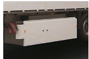
Bordwände können in einem speziellen Palettenkasten verstaut werden.
