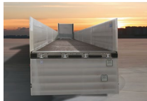
Sicherer Aufstieg auf die Ladefläche über Trittstufen an der Heckklappe.
