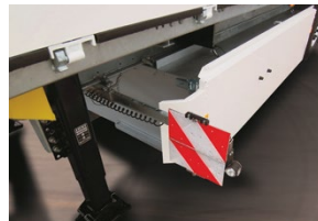
Herausziehbare Warntafeln vorn und hinten für überbreite Transporte sind in der Serienausstattung enthalten.
