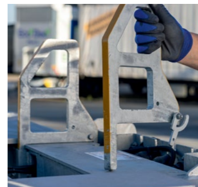
Leicht auswechselbare Containerführungen für Container am Frontbalken.
