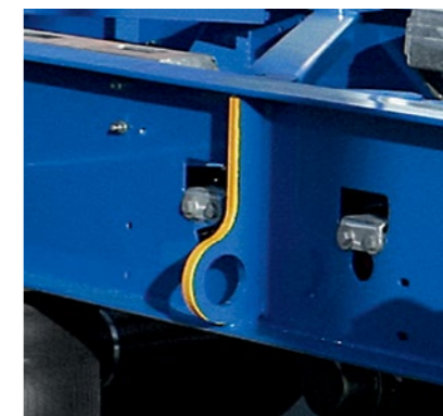
Für den Einsatz im Fährverkehr kann das Sattelcontainer-Fahrgestell mit Ferry Lashings* ausgestattet werden.
