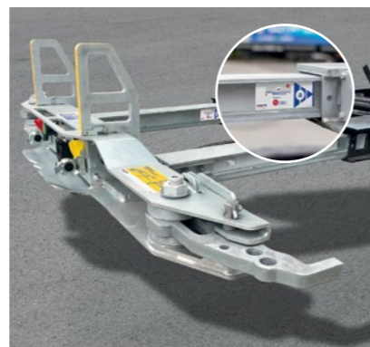
Mechanischer Frontausschub für 45' Container ist federnd rollengelagert und im Handling einfach und sicher.
