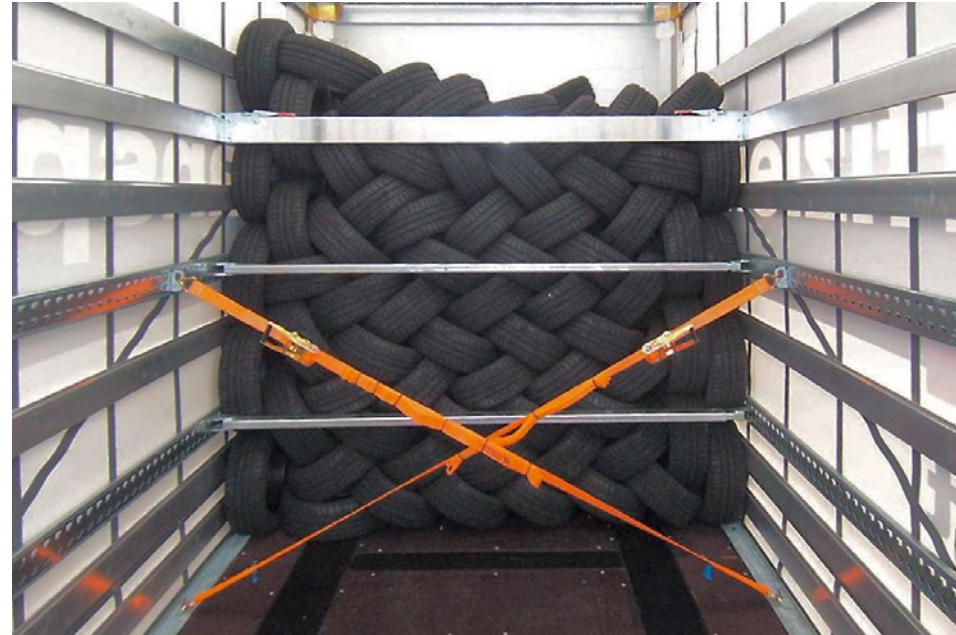
Lose Reifen in der gebrezelten Anordnung neigen dazu, sich beim Transport zu setzen und einen starken seitlichen Druck auszuüben. Hier muss die seitliche Aufbaustabilität sichergestellt werden.
