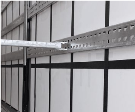
Plane mit Verstärkungsgurten und Ladungssicherungsbalken bei Teilbelastung.
