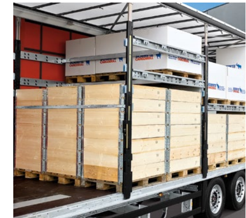
Querbalken können zum formschlüssigen Sichern von Teilladungen in die Rungen und seitlichen Doppelstock-Tragebalken eingehängt werden.
