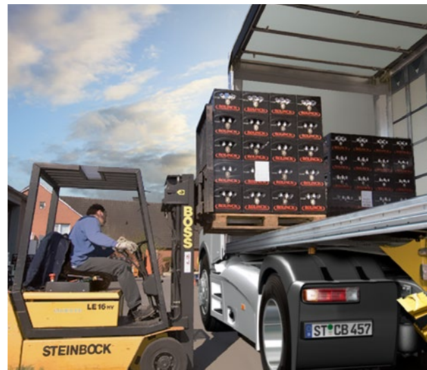
Formschlüssig geladene Getränkeketten können bei entsprechender Ausstattung ohne Niederzurren sicher transportiert werden.
