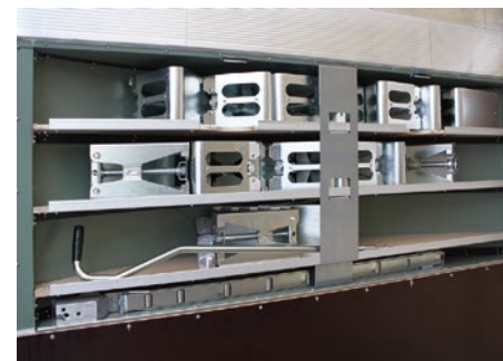
Staukisten – hier in die Stirnwand integriert – stellen sicher, dass die notwendigen Teile jederzeit verfügbar sind.
