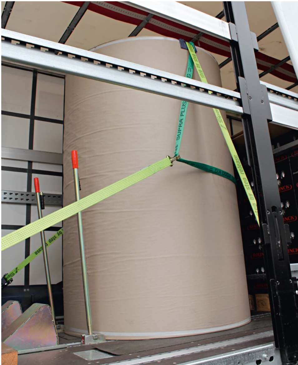
Papierrollen-Transport mit Sicherung durch Form- und Kraftschluss. Die Kopflasche der stehenden Rolle sichert auch gegen Kippen.
