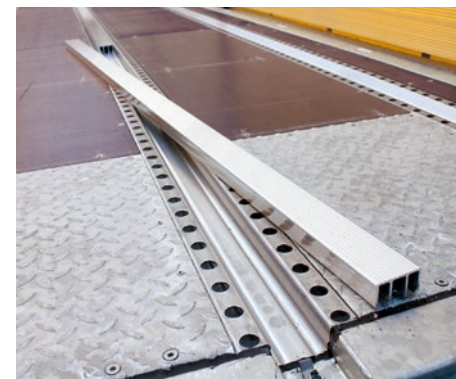
Die Joloda-Schiene mit Lochraster und stabilen Aluminium-Abdeckungen sind einfach zu reinigen und erleichtern das Handling und Sichern der Ladung.
