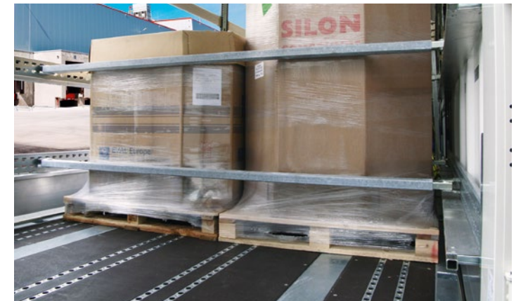
Waagrecht eingesetzte Aufsatzlatten stellen den seitlichen Formschluss bei palettierten Oktabins her. Sperrbalken sichern in Längsrichtung.
