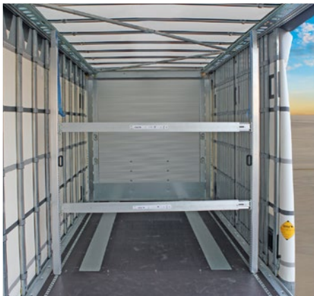
Ein System aus Stützen und Sperrbalken zur freien Positionierung.
