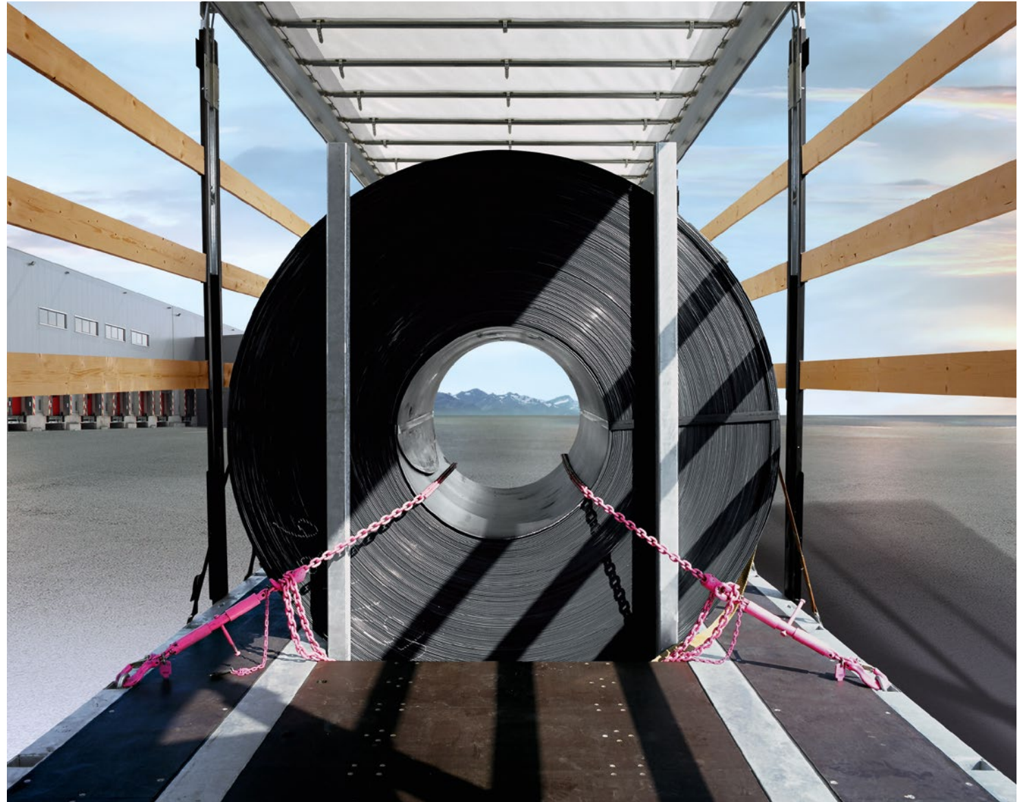
Formschlüssige Sicherung eines Stahl-Coils durch eine spezielle Mulde, steckbare Rungen und Ketten in Schwerlastzurrösen verankert.
