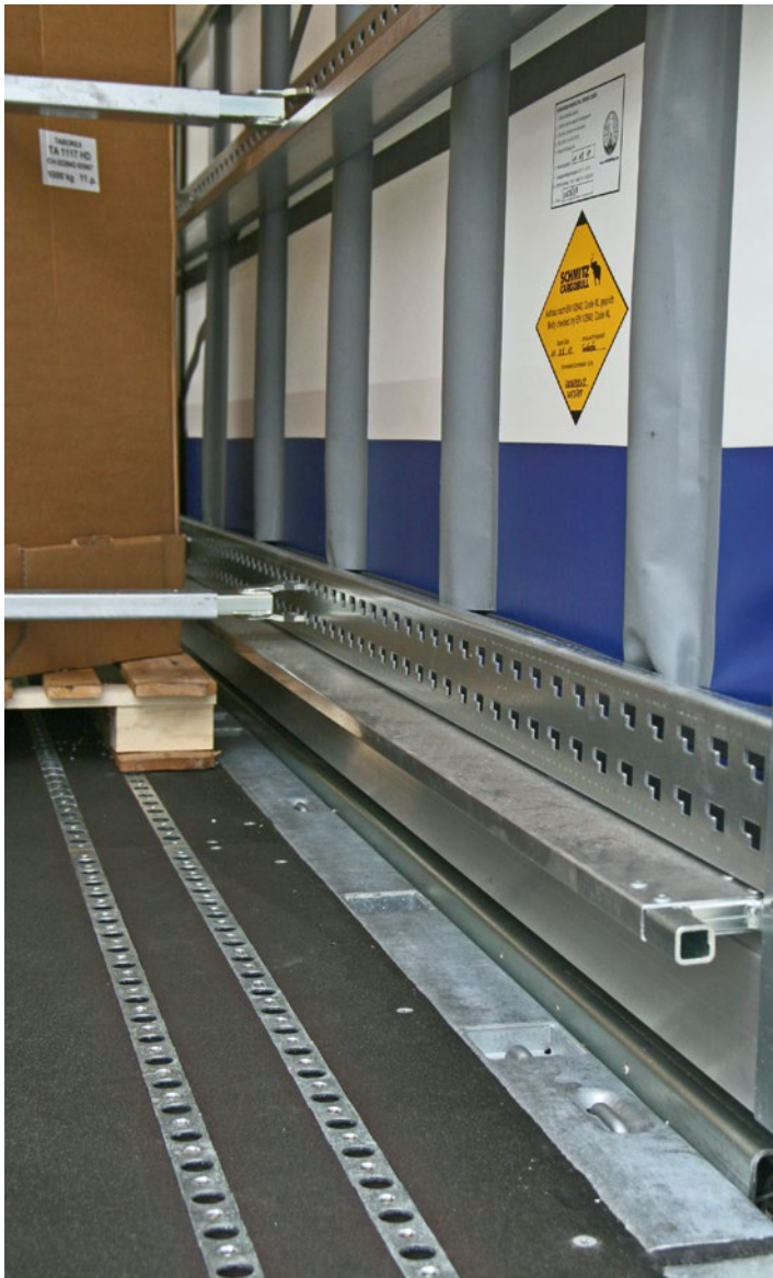
Ladelücken zur Seite sind durch klappbare Latten schnell und sicher überbrückt.
