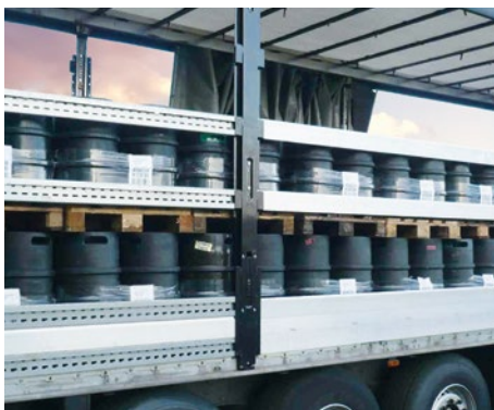
Formschlüssige Ladung aus gebänderter Fassware.
