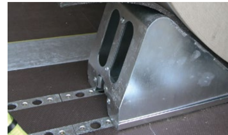
Formschlüssige Blockade der Rolle durch spezielle Keile in Verbindung mit Antirutschmatten.
