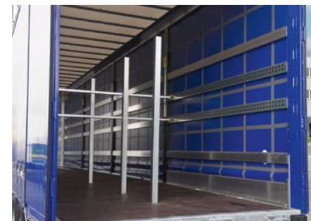
Für den Transport von Profilen und Stangenmaterial: Zusätzliche Rungen und Stahl-Aufsatzlatten mit waagerechten Balken.
