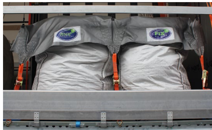
Formschlüssige Sicherung bei nachgiebigen Big Bags: Untere Seitenlatte aus Aluminium und Plane mit Zurrgurten.
