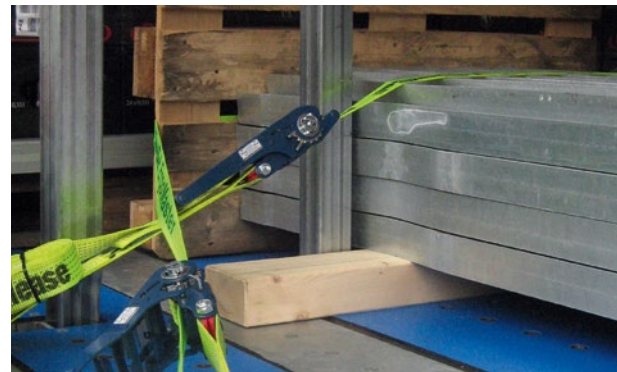
Formschlüssig zur Seite und nach vorne gesichert und niedergezurrt.
