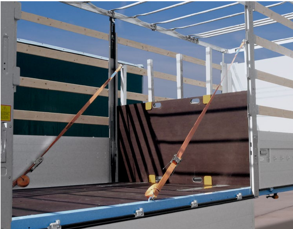
Eine zusätzliche, mitten auf der Ladefläche eingezogene Wand sollte zum Chassis hin abgespannt werden, um die Kräfte bei formschlüssiger Ladung aufnehmen zu können.
