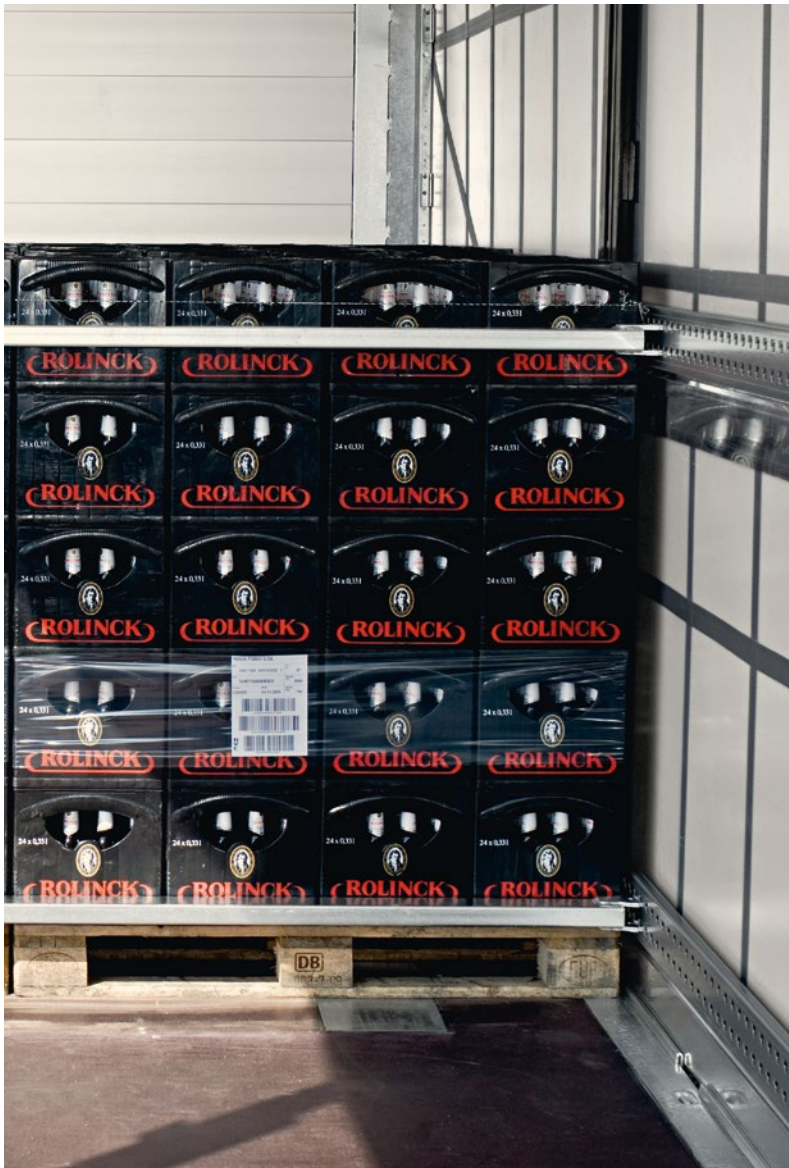
Querbalken vor und hinter der Fracht sichern Teilladungen gegen Verrutschen in Längsrichtung.
