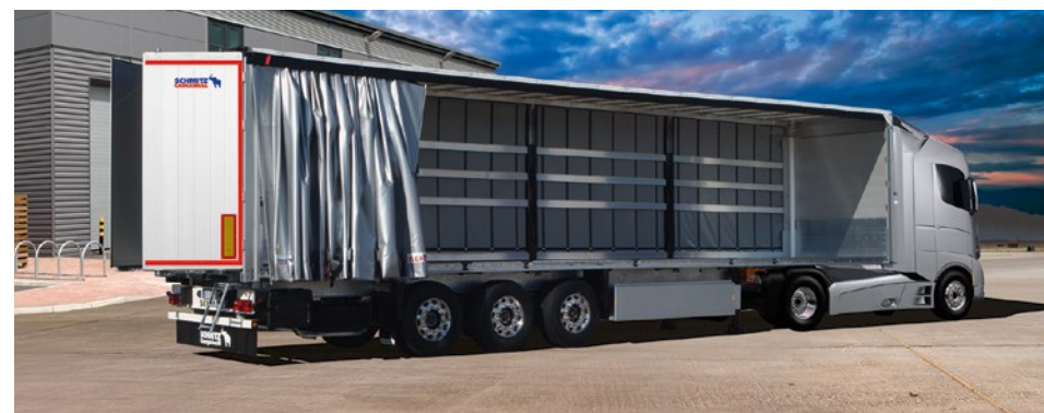
Ein stabiler Aufbau ist die Voraussetzung für eine Ladungssicherung durch Formschluss.
