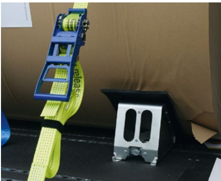
Keile sichern formschlüssig eine Papierrolle, Zurrgurte erhöhen den Anpressdruck.
