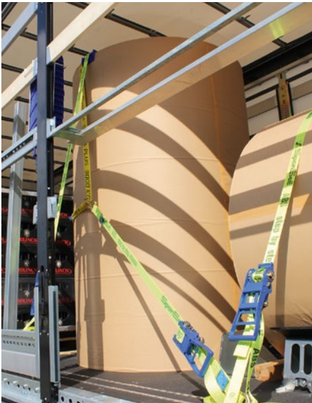
Papierrolle stehend, gesichert durch Direktzurren mit Kopflasche und Niederzurren.
