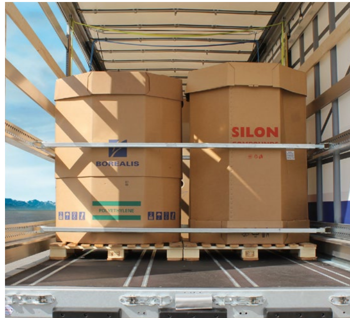
Oktabins auf Paletten werden idealerweise formschlüssig durch Querbalken gesichert.
