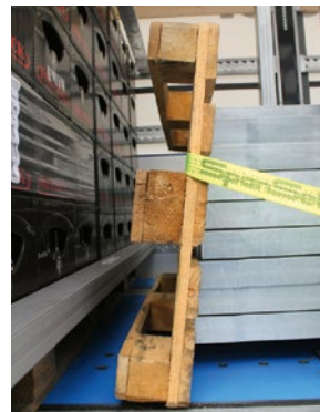
Eine einfache Lösung zur formschlüssigen Sicherung ist eine aufgestellte Palette, die über Gurte abgespannt wird.
