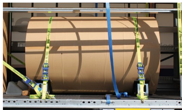
Liegende Papierrolle längs zur Fahrtrichtung. Niedergezurt mit 2 Gurten und nach vorn gesichert mit Sicherungskeilen.
